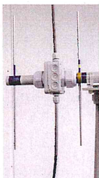
Bild 8: Die Elemente an und in der Nähe der Feuchtraumdose
