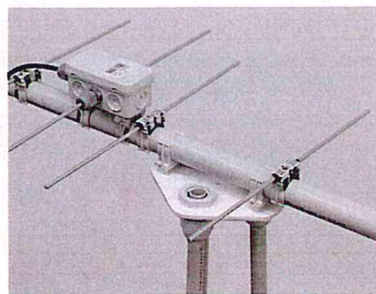
Bild 6: Obere Platte mit „eingeklickter“ Yagi mit konventioneller direkter Speisung. Zu erkennen sind zwei \lambda/4 lange aufgeklebte Aluabschirmungen auf dem Koaxialkabel, mit Lücken von ebenfalls \lambda/4 sowie die Farbcodierung der Elemente
